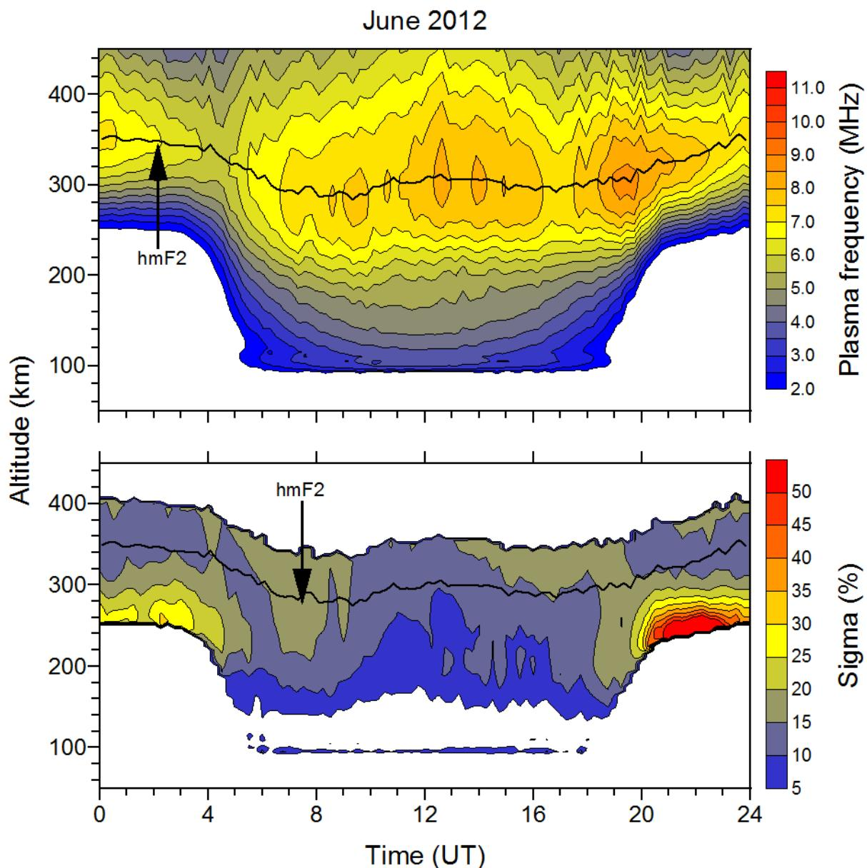
Variació diürna típica de la densitat electrònica (Freqüència de plasma) i la seva desviació estàndard (%) a sobre de l'observatori en funció de l'altura.
