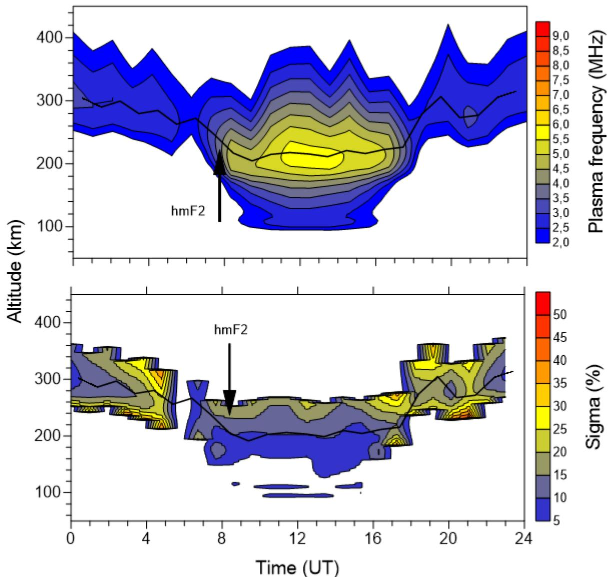
Variació diürna típica de la densitat electrònica (Freqüència de plasma) i la seva desviació estàndard (%) a sobre de l'observatori en funció de l'altura.
