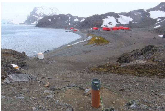
Emplaçament del nou magnetòmetre d'efecte Overhauser, ubicat a l'interior d'uns tubs de PVC per protegir-lo de les inclemències del temps. Al fons la base antàrtica espanyola Juan Carlos I.
