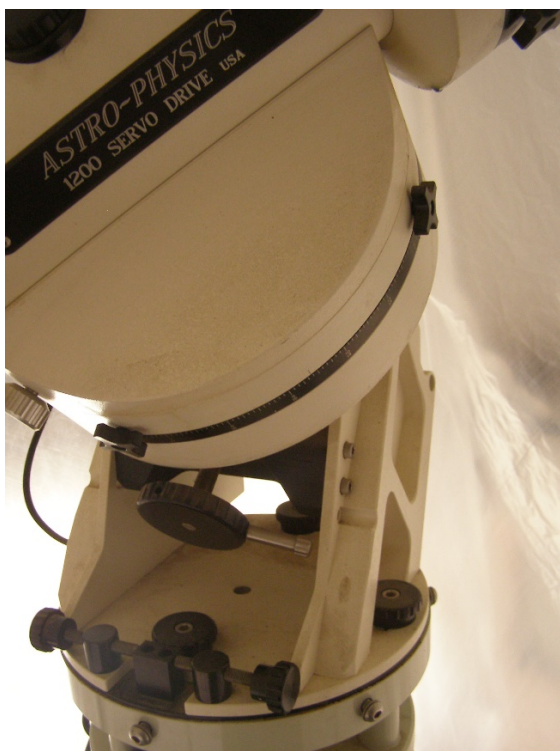
Fig. 14. Detall de la muntura equatorial del telescopi solar. Detalle de la muntura ecuatorial del telescopio solar.
