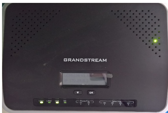
Fig. 18. Detall de centraleta de telefonia sobre veu IP. Detalle de la centralita de telefonía sobre voz IP.
