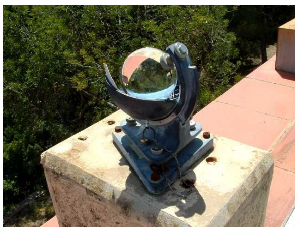
Fig. 8. Detall de l'heliògraf Campbell-Stokes que s'utilitza per la mesura de la insolació. L'extensió de la cremada enregistrada sobre la cartolina negra indica les hores de sol. Detalle del heliógrafo Campbell-Stokes que se utiliza para la medida de la insolación. La extensión de la quemadura registrada en la cartulina negra indica las horas de sol.
