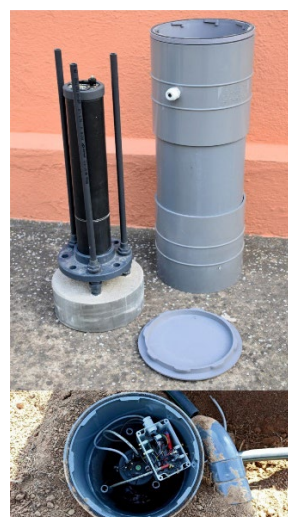
Fig. 4. A dalt: magnetòmetre Lemi044 (esquerra) i el seu contenidor impermeable de PVC fet a mida (dreta), que, per a la correcta anivellació i orientació, inclou una base de formigó per proporcionar estabilitat amb cargols d'anivellament fixats amb cilindres de PVC accessibles des de la part superior. A baix: El magnetòmetre col·locat dins del seu contenidor està enterrat per atenuar l'oscil·lació tèrmica. L'electrònica situada a la part superior conté el mòdul de transmissió de dades. Arriba: magnetómetro Lemi 44 (izquierda) y su contenedor impermeable de PVC hecho a medida (derecha), que, para su correcta nivelación y orientación, incluye una base de hormigón para proporcionar estabilidad con tornillos de pie de nivelación fijados con cilindros de PVC accesibles desde la parte superior. Abajo: El magnetómetro colocado dentro de su contenedor está enterrado para atenuar la oscilación térmica. La electrónica situada en la parte superior contiene el módulo de transmisión de datos.
