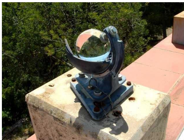
Fig. 14. Detall de l'heliògraf Campbell-Stokes que s'utilitza per la mesura de la insolació. L'extensió de la cremada enregistrada sobre la cartolina negra indica les hores de sol. Detalle del heliógrafo Campbell-Stokes que se utiliza para la medida de la insolación. La extensión de la quemadura registrada en la cartulina negra indica las horas de sol.
