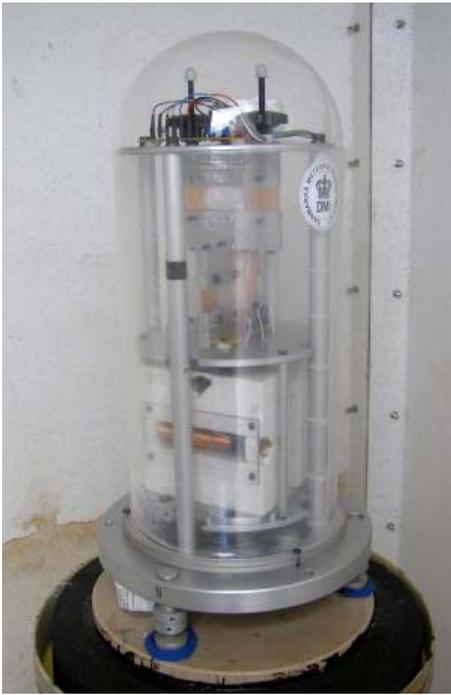
**Figura 4 – Magnetómetro triaxial suspendido, basado en sensores fluxgate, en operación en el observatorio de la Isla Livingston.**
